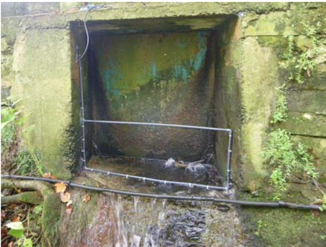
Foto 9. Antena 4 de detección, bypass cerrado
