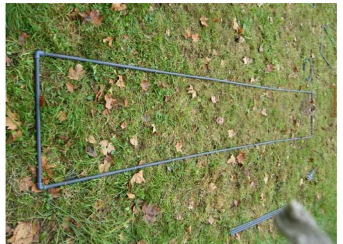
Foto 6. Detalle antena rectangular de toma (4x0,80 m)
